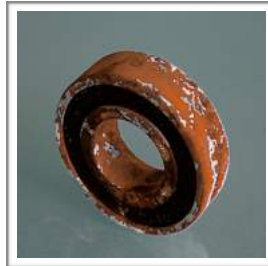
Unbeschichtet nach 24 Stunden im Salzsprühnebeltest
