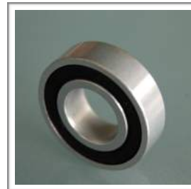
Acosur® ZNA Beschichtet nach 500 Stunden im Salzsprühnebeltest
